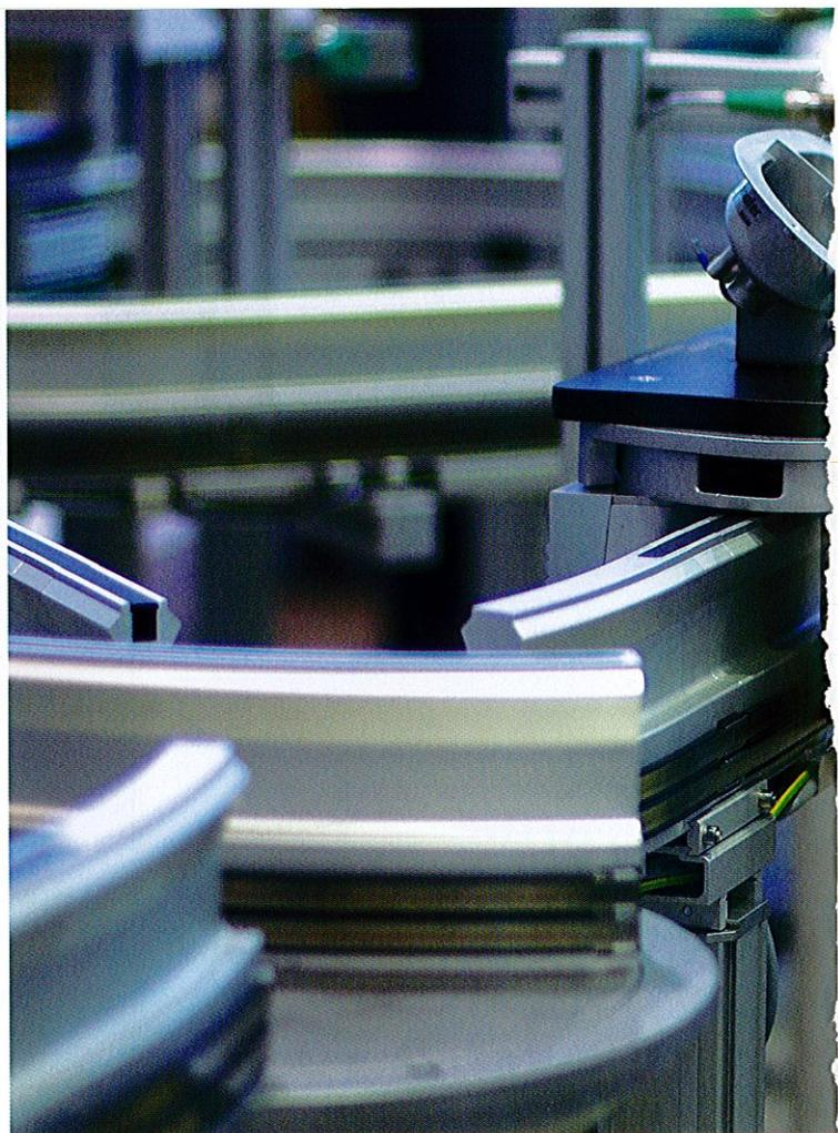
*Selbststeuernder Prozess: Das Werkstück fährt dorthin, wo seine Weiterverarbeitung am sinnvollsten ist. Erst später entscheidet sich, ob es ein farbiges oder ein transparentes Rücklicht wird.*
