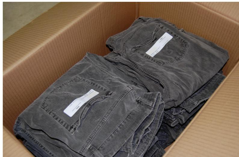
Abbildung 1: Bekleidungsstücke mit selbstklebenden RFID Papiertranspondern
