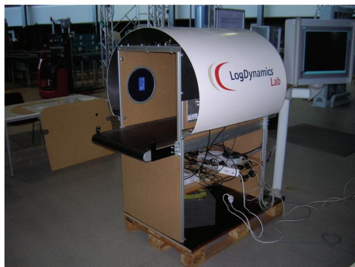
Abbildung 2: RFID Tunnelreader des LogDynamics Lab Bremen
