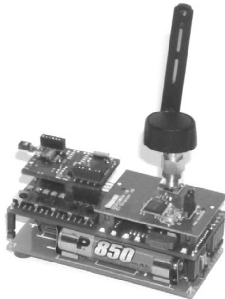
Abb. 5: Sensorknoten zur drahtlosen Übertragung von Messwerten innerhalb des Containers. Derzeit stehen Module für Temperatur, Feuchtigkeit, Licht und Erschütterungen zur Verfügung.
