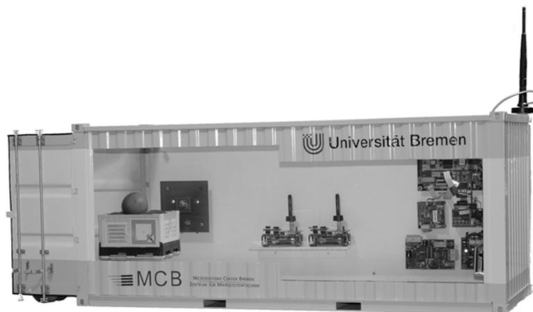
Abb. 1: Prototyp des „Intelligenten Containers“ im Maßstab 1:8. Auf der linken Seite befindet sich der RFID-Reader, in der Mitte zwei Sensorknoten. Ein Scheckkarten großes Prozessormodul an der rechten oberen Rückwand übernimmt die lokale Überwachung. Die Übertragung der warenspezifischen Informationen und der Versand von Warnmeldungen bei drohendem Qualitätsverlust geschehen über das externe Kommunikationsmodul an der rechten Seitenwand.
